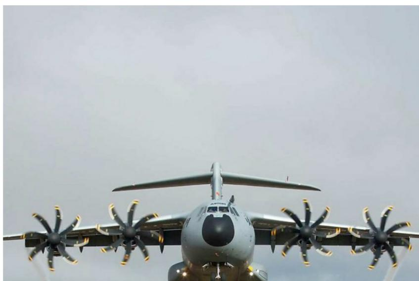
Avant l'accident de Séville, le logiciel de régulation de la puissance des quatre turbopropulseurs aurait été mal téléchargé durant la phase dite de « prévol » - Sylvain Ramadier/Airbus
