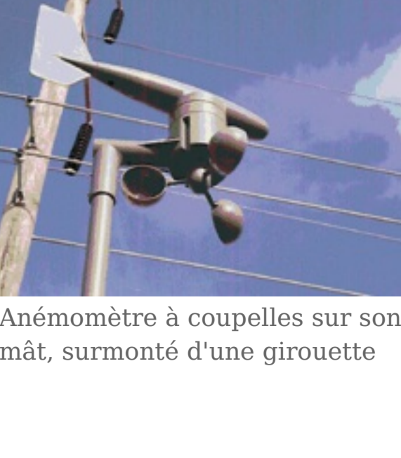
Anémomètre à coupelles sur son mât, surmonté d'une girouette
