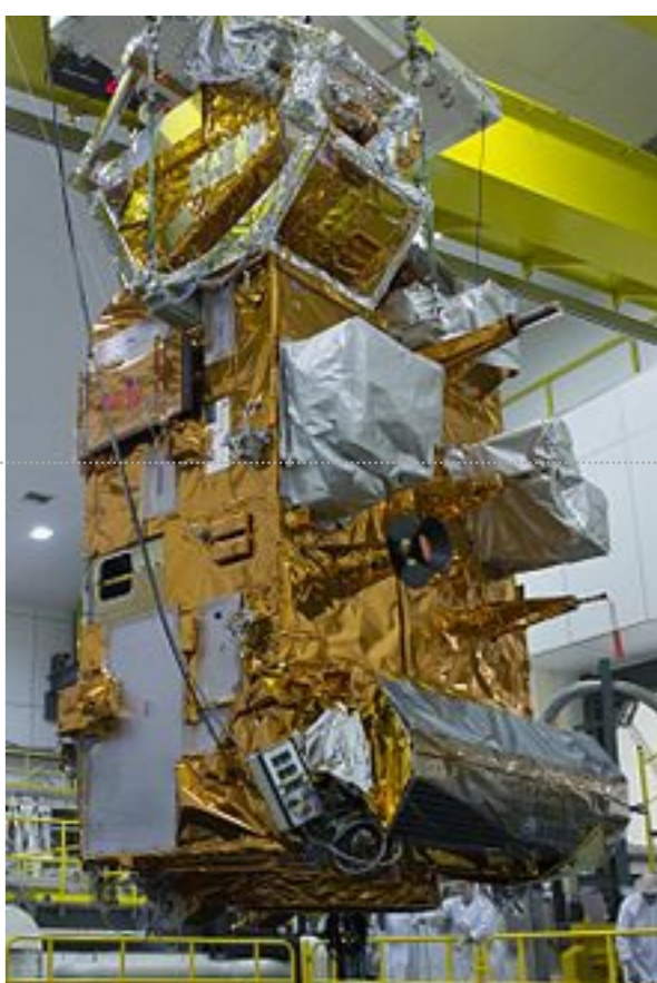
MetOp-C est en cours d'installation dans le simulateur d'environnement spatial (LST) de l'ESTEC (Centre spécialisé de l'Agence spatiale européenne.
