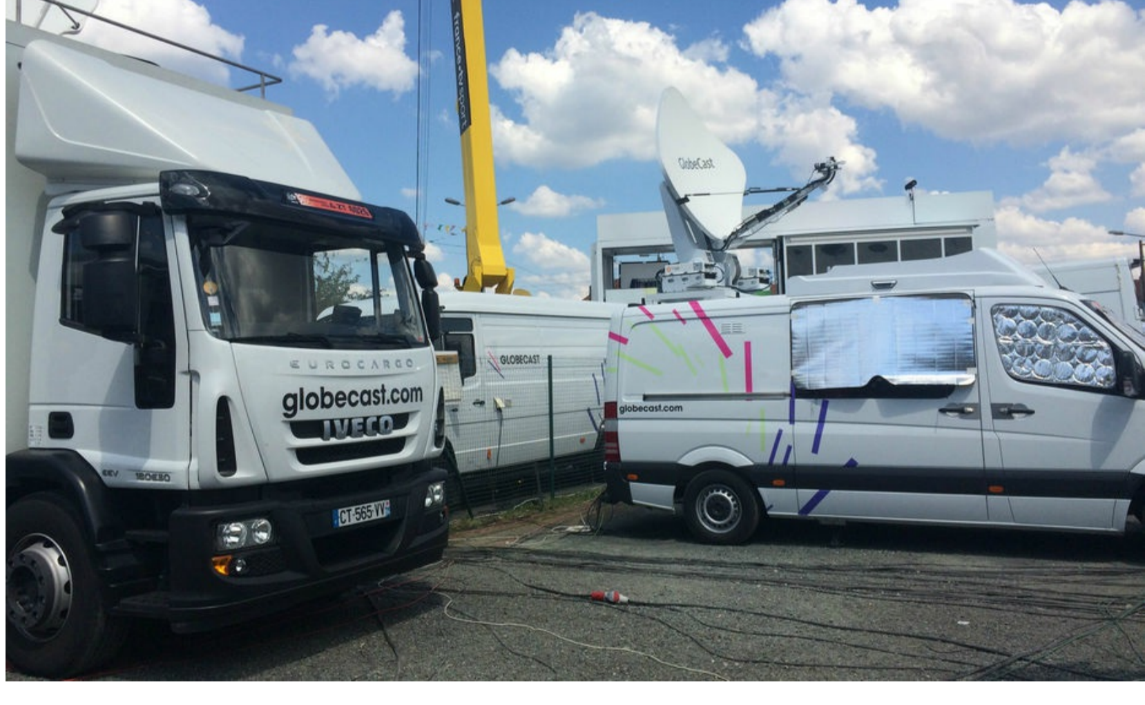
(Parabole et antenne -grue jaune- présents pour la réception du signal en zone technique)
