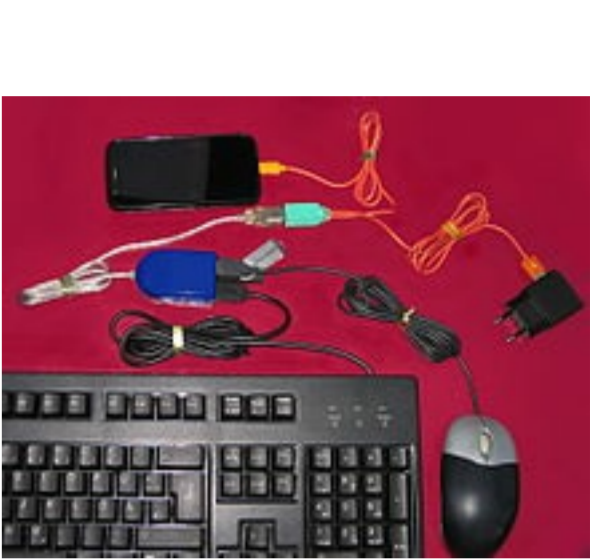
Configuration USB OTG avec concentrateur USB et autres périphériques
