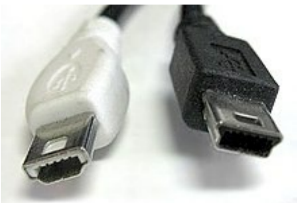
Câble mini-A (à gauche) vers mini-B (à droite).
