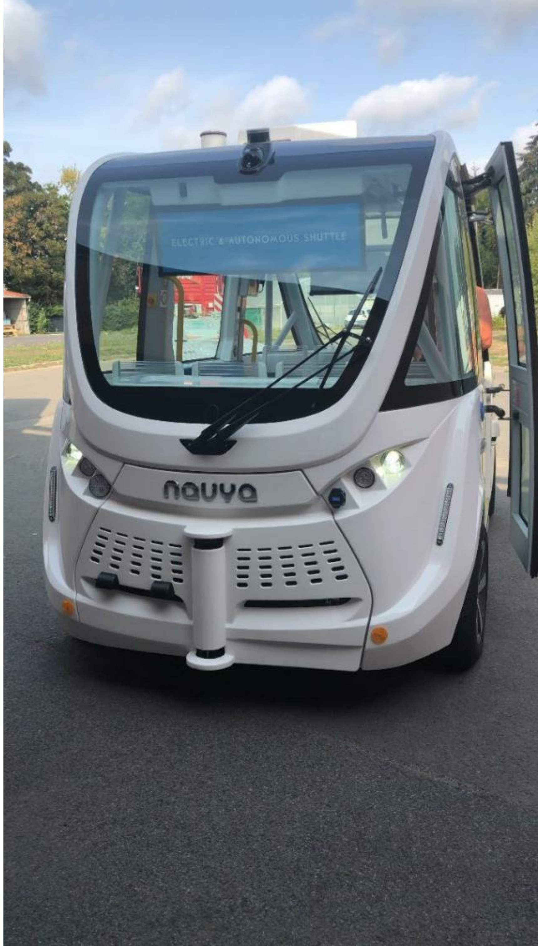
Des caméras, capteurs, antennes détectent les obstacles et estiment leur position par rapport au véhicule. | Rennes métropole
