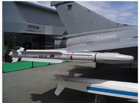
Missile MICA IR sur un Dassault Rafale M.
