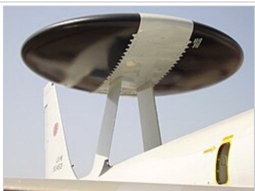
Vue rapprochée du radar qui effectue six tours par minute 18 .
