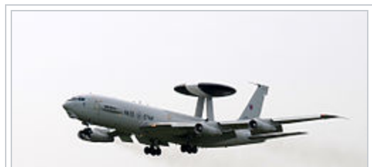
Les E-3 de l'OTAN ont l'immatriculation LX sur la dérive 25 . Le carénage de menton accueille une suite ESM 25 .
