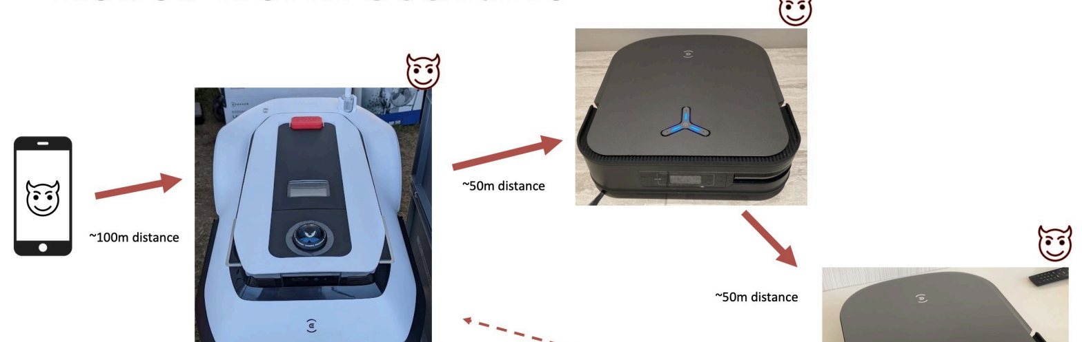
Le code PIN permettant de sécuriser le flux vidéo d'un aspirateur robot Ecovacs est authentifié côté application, ce qui rend le mécanisme extrêmement vulnérable Source
