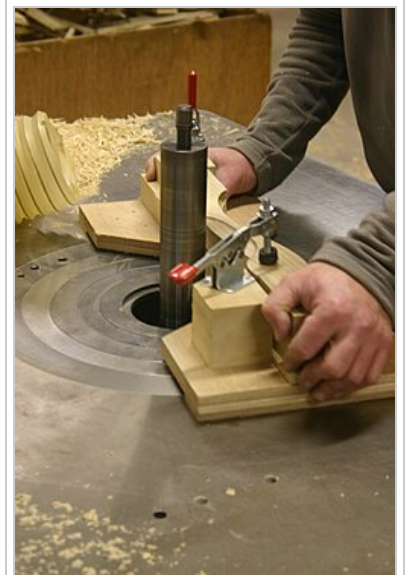
Toupillage au gabarit d'une pièce de bois (attention les protecteurs réglementaires ne sont pas en place)
