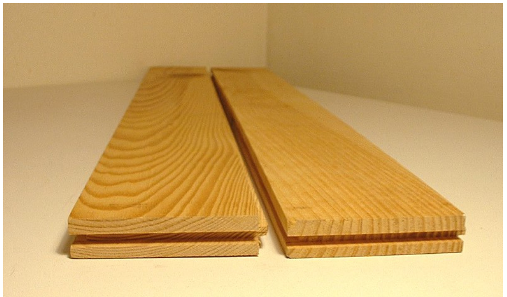
Deux planches prêtes à être assemblées : languette à gauche, rainure à droite.
