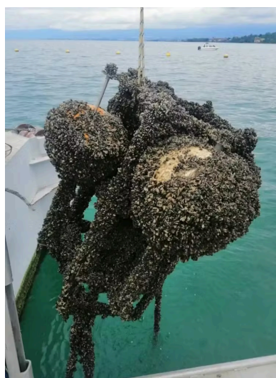
Instrument de mesure scientifique entièrement colonisé par la moule quagga après une année d'immersion dans le lac à la profondeur de 8 mètres. LÉXPLORE, Sébastien Lavanchy
