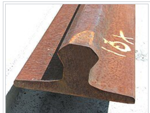
Section du rail du système de guidage (lors de la pose à Clermont-Ferrand en 2006).
