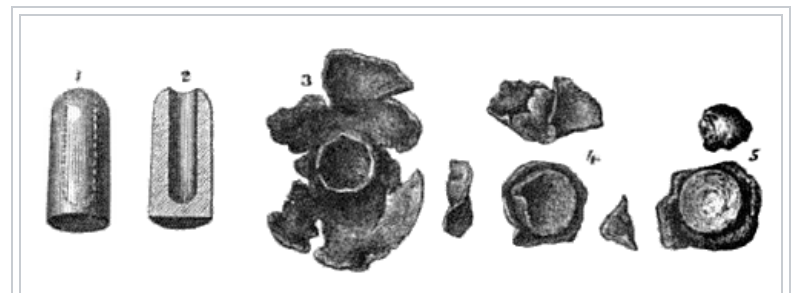
Dessins de 1870 d'une balle de fusil Hollow point express avant le tir (1, 2) et après récupération du gibier (3, 4, 5), montrant l'expansion et la fragmentation.
