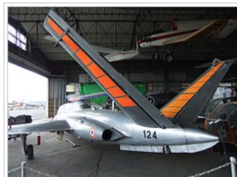
Détail sur l'empennage en V, la quille et sa roulette intégrée
