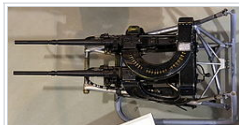
Mitrailleuses AA 52 7,5 mm sur le bâti tubulaire de la pointe du Magister
